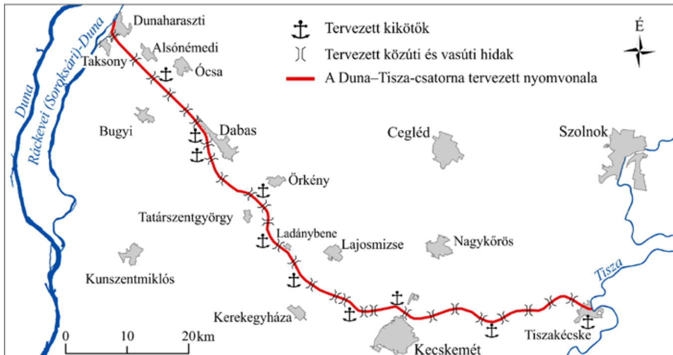
A kivitelezésre elfogadott Duna-Tisza-csatorna helyszínrajza
