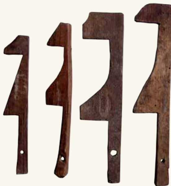
Fogtávolságot mérő módlák, a nagykerék fogainak távolságához szolgáltak mintaként
